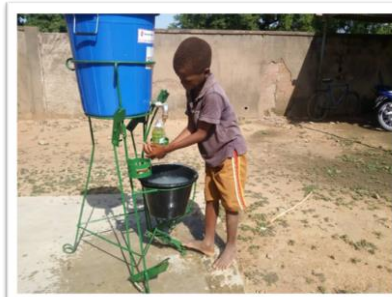
Un dispositif de lave-main installé dans les guichets uniques de service à Faramana
